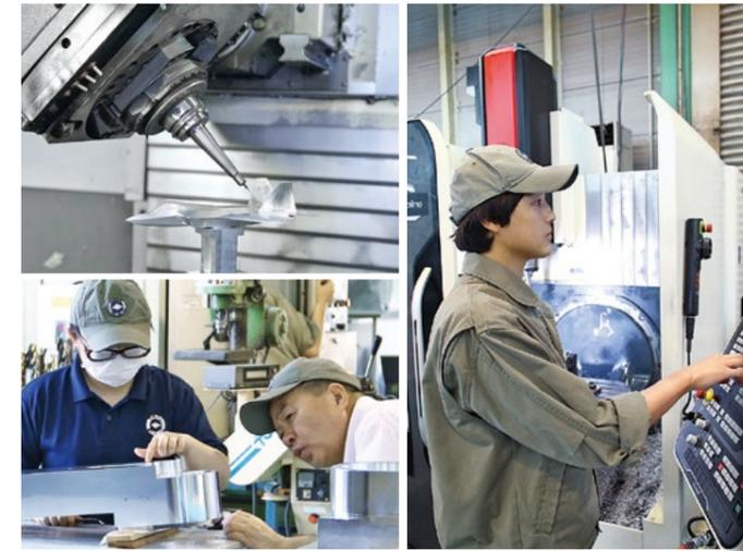
小さな部品まで、大きささまざまな部品を製造。金属をあらゆる角度から自在に削って加工できる5軸加工機という機械を使って複雑で繊細な部品を製造することができます。加工できる金属は削るのが難しいとされるチタンや銅、ニッケル、アルミなど多種にわたり、発注者のニーズに細かく応えることができます。そのほか、金属プレス加工で光通信に使われる電子部品なども製造しています。
