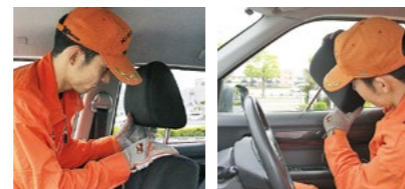
ヘッドレストの鉄棒をガラスの隙間に差し込む
