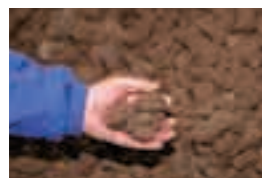
西別府管理型クローズド式最終処分場に埋め立てられる飛灰固化物（霧島市が埋め立てるものもこれと同じ）
