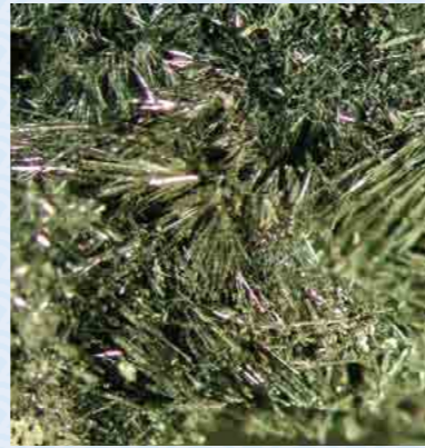
輝安鉱：アンチモンの硫化物(アンチモンと硫黄の化合物)。独特の金属光沢を持つ針状の結晶が特徴。
