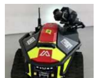
無人走行放水ロボット
