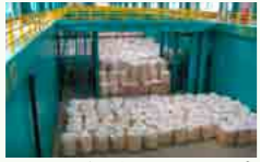
飛灰固化物は大型土嚢袋に詰めて静置
