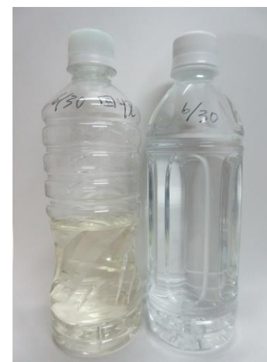
図3 苦情品変色したボトル（左） テスト品変色なし（右）
