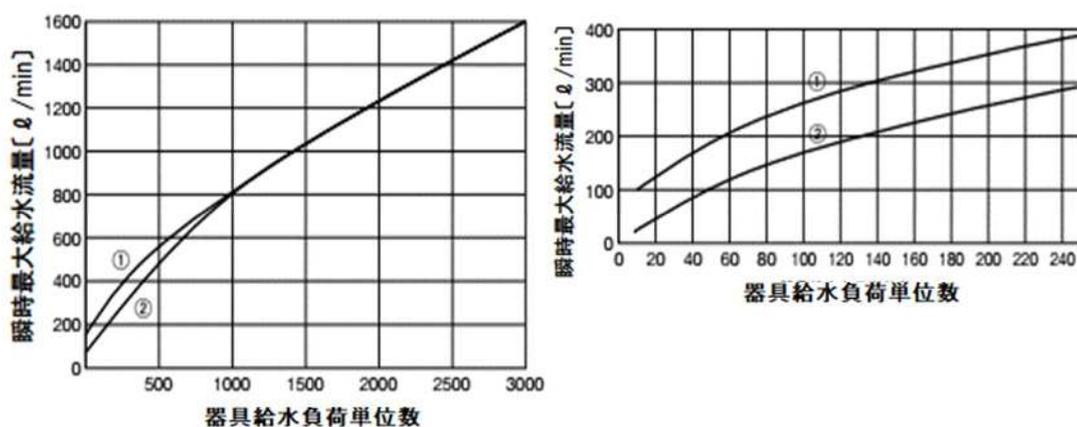
注 この図の曲線①は大便器洗浄弁の多い場合、曲線②は大便器洗浄水浄水槽の多い場合に用いる。
