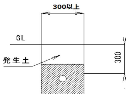
埋め戻し材は原則として発生土流用とするが、土質に応じて管防護の為、洗砂使用も考慮すること。
