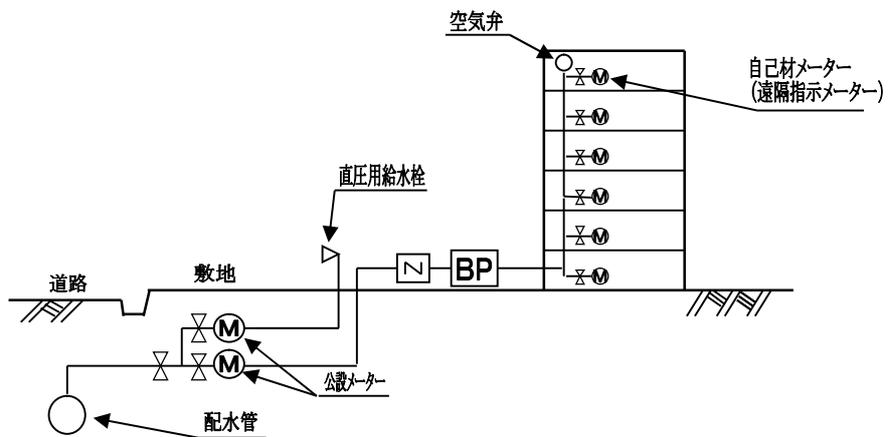
3. 直結増圧式給水と直結直圧式給水及び受水槽式給水の併用図
