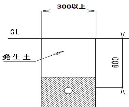
埋め戻し材は原則として発生土流用とするが、土質に応じて管防護の為、洗砂使用も考慮すること。
