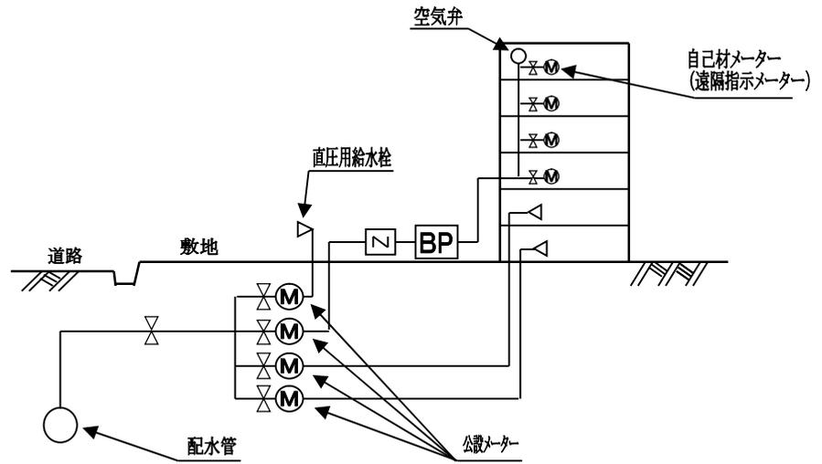
※直結直圧式と併用給水する場合は、直結直圧式給水階数は3階までとする。
