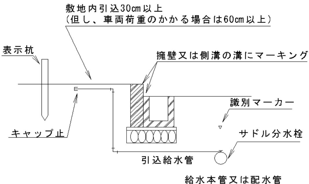
引込(量水器)位置は敷地の入口付近に取付け、検針が容易であり、折損や漏水の恐れのない場所とする。
