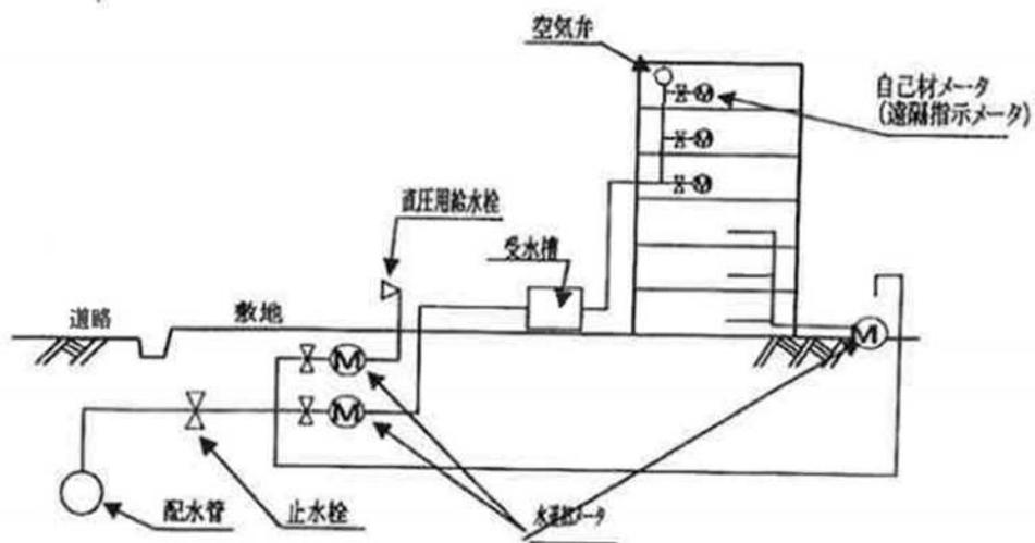
※直結直圧式と併用給水する場合は、直結直圧式給水階数は3階までとする。
