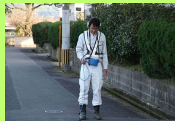
漏水調査の重点的实施
